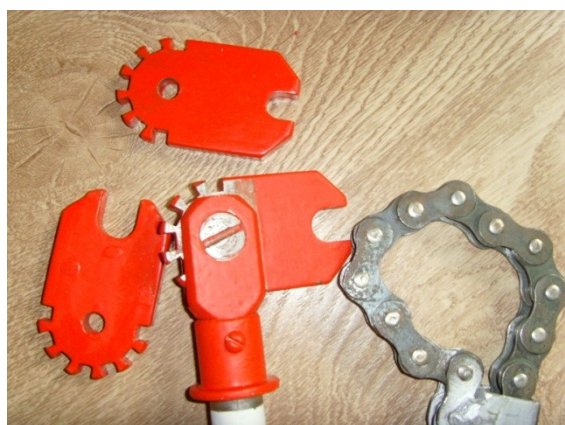
Рисунок 2-Чертёж ключа с ломающейся ручкой[3]
